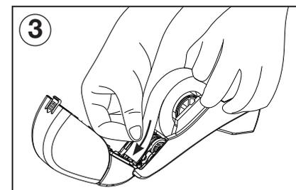
Tire de la cinta 30-40 mm para que la punta quede en el extremo y la cinta restante descansa fácilmente sobre la fila de las bandas de goma.
