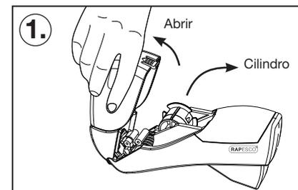
Presione "ABRIR" en la parte posterior de la tapa transparente y saque el rodillo.
